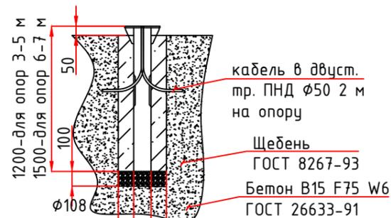
Бетонировать по технологии монтажной организации для обеспечения устойчивости и нагрузки на опору
